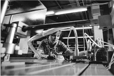
Abb. 294 | Der erste Nähroboter für die DDR-Textilindustrie wurde im Jahr 1980 in Betrieb genommen. Hier richtet eine Kleidungs-facharbeiterin den Nähroboter ein, der automatisch die Hosentaschen für Herrenhosen fertigt.
