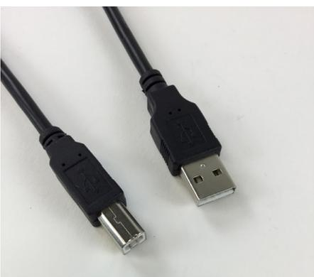
Abb. 190 | USB-Kabel mit Anschluss für den Computer und für den Arduino
