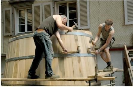
Abb. 120 | Küfer bei der Herstellung eines Eichenfasses
