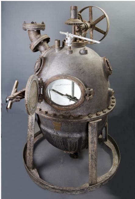
Abb. 36 | Mithilfe des Bakelizers gelang Baekeland die Herstellung des ersten vollständig synthetischen Materials – des Bakelits.
