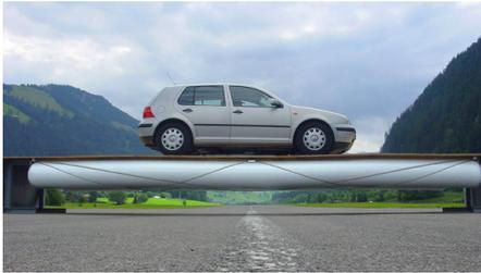
Abb. 140 | Die Tensairity-Brücke besteht zu einem Grossteil aus Luft und hält dennoch einem Gewicht von zwei Kleinwagen stand.
