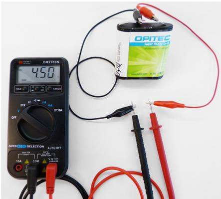
Abb. 155 | Spannungsmessung an einer 4,5-V-Batterie
