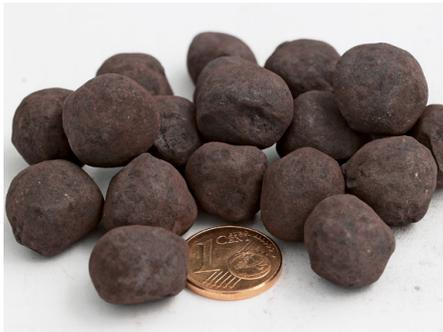
Abb. 54 | Eisenerzpellets für die Stahlproduktion
