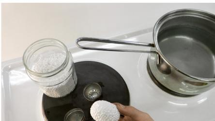
Abb. 48 | Nach einer ersten Trocknungsphase wird das vorgeschäumte Material in eine Stahl- oder Aluminiumform (hier ein Tee-Ei) gegeben. Die Form wird bis oben gefüllt und geschlossen. Nun wird über Düsen Dampf eingeblasen, der über andere Düsen wieder abgeführt wird. Durch die Hitze bläht sich das Material weiter auf. Es entsteht ein enormer Druck in der Form, und die Kügelchen verkleben zu einem grossen Block.
