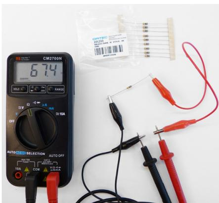
Abb. 157 | Widerstandsmessung an einem Widerstand
