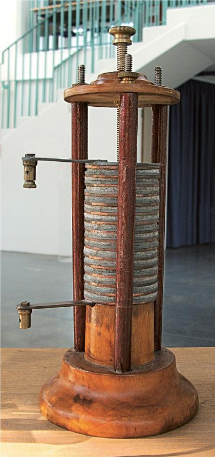
Abb. 112 | Nachbau einer voltaschen Säule. Zink- und Kupferplatten werden durch in Salzlösung getränkte Pappstücke getrennt. Verbindet man die beiden Endplatten miteinander, fließt Strom.
