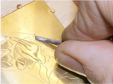
Abb. 127 | Mit einem Stichel verziert ein Graveur eine Messingoberfläche.
