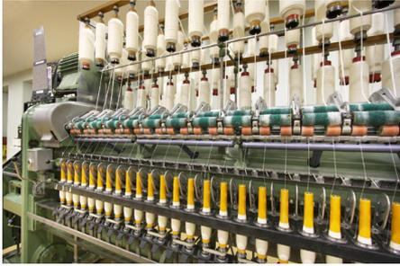
Abb. 78 | Ringspinnmaschine
