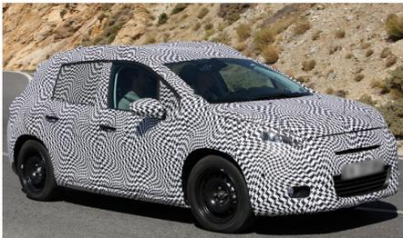
Abb. 102 | Erlkönig des Peugeot 306 aus dem Jahr 2013. Um die Form des Erlkönigs zu verschleiern, wurde das Auto komplett mit Folie abgeklebt.
