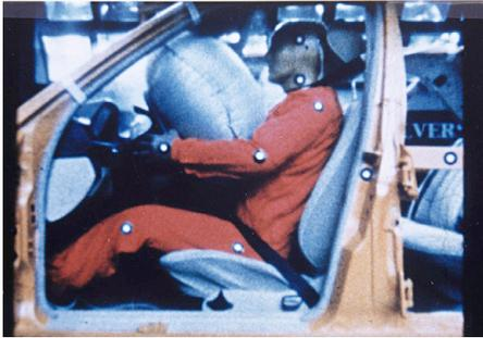
Abb. 108 | Bei einem Aufprall lösen Sensoren den Airbag aus, der sich innerhalb von Millisekunden aufbläst.
