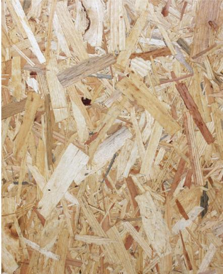
**Abb. 20 | Oberfläche einer Grobspanplatte.**
