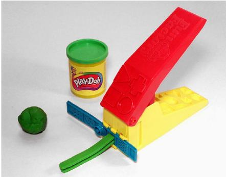
Abb. 123 | Kolbenextrusion von Knetmasse mit einem Kinderspielzeug
