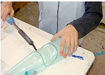
Abb. 45 | Thermoschneiden mit dem LötKolben
