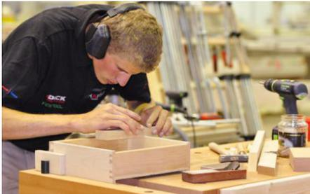
Abb. 115 | Ein Möbelschreiner bei der Fertigung eines Schubladenelements
