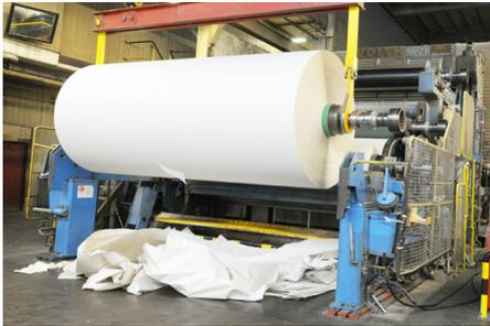
Abb. 130 | Die Papiermaschine übernimmt die eigentliche Produktion. Das fertige Papier wird anschliessend auf grosse Rollen aufgewickelt.
