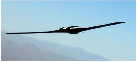
Abb. 175 | Das unbemannte Flugzeug Lockheed Polecat besteht zu einem Grossteil aus gedruckten Kunststoffbauteilen.
