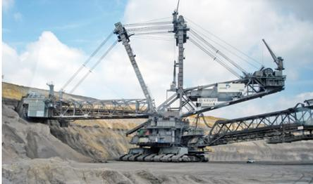
Abb. 209 | Der Schaufelradbagger 288 bei der Arbeit
