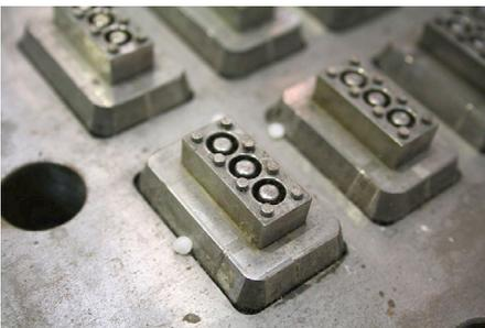
Abb. 122 | Unterseite eines LEGO-Spritzgusswerks
