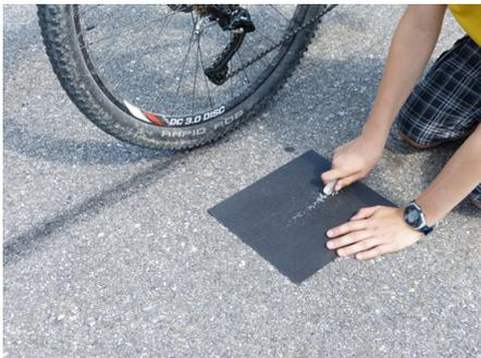
Abb. 35 | Testet den Gummiverbrauch eines Reifens. Ein Radiergummi auf einem Schleifpapier verliert bei raschem Darüberfahren viele Gummikrümel. So ist es auch beim Fahrrad- oder Autoreifen: Bremsst man scharf, sodass die Reifen quietschen, sieht man anschliessend schwarze Bremsstreifen auf der Strasse.
