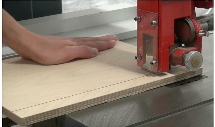
**Sägen:** Das Werkstück langsam, gleichmässig, aufmerksam und bei zu kleinem Abstand mit Stosshölzern gegen das Sägeblatt schieben.
