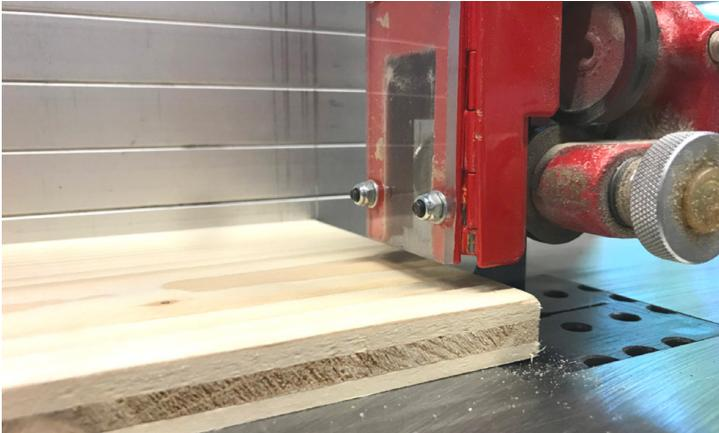
**Blattschutz:** So einstellen, dass der Abstand zum Werkstück maximal 15 mm beträgt.
