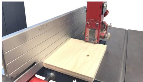
**Längsansschlag:** Dieser Anschlag ist geeignet für Längsschnitte (z. B. Zusägen von Holzwerkstoffen oder Massivholz)
