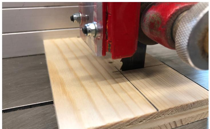
**Einschnitte:** Beim Sägen von Einschnitten das Werkstück erst nach Stillstand der Säge zurückziehen.
