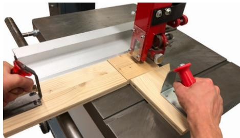
**Stosshölzer:** Wenn das Werkstück zu schmal oder der Abstand zum Sägeblatt kleiner als eine Handbreite ist, unbedingt Stosshölzer einsetzen.
