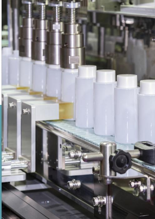
Das fertige Duschmittel wird abgefüllt, die Flaschen werden verschlossen.
