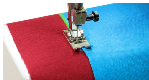
Lineares Sticken mit Grundstichen: Dank Transporteur ohne Stickrahmen möglich.
